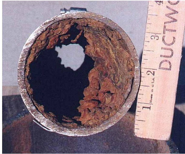
شکل ۴۵: نمونه ای از تاثیر باکتری های تولید رسوب در خوردگی یک خط لوله [۵]
