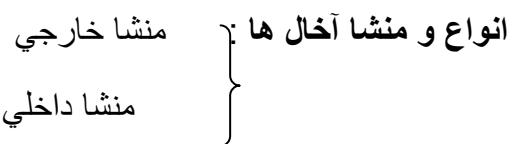
خارجی : مثل شکستن دیواره بوته و یا ماسه شویی و داخل مذاب می شود شامل آلومینا ، سیلیس ، کاربید سیلیسیم . اندازه ذرات می تواند بین  $1\text{ }\mu\text{m-mm}$  باشد.
