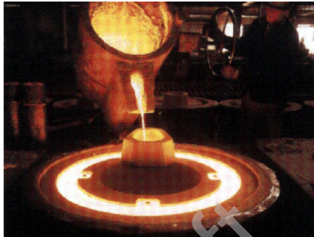
شکل ۱: بارریزی فلز در قالب
