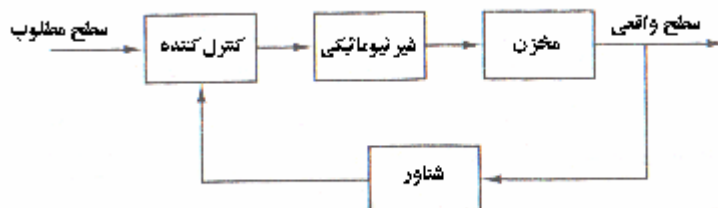
شکل ۲-۵ نمودار بلوکی سیستم کنترل سطح مایع
