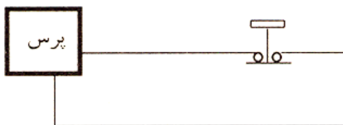
شکل ۲-۱۴ استفاده از پوش باتون NC برای فرمان حرکت پرس
