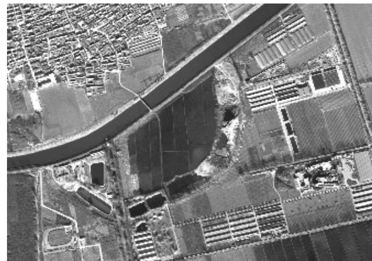
شکل ۵-۱۷: یک منطقه شهری (تصویر ماهواره‌ی WorldView-1 با قدرت تفکیک ۵۰ سانتی در باند سیاه و سفید)
