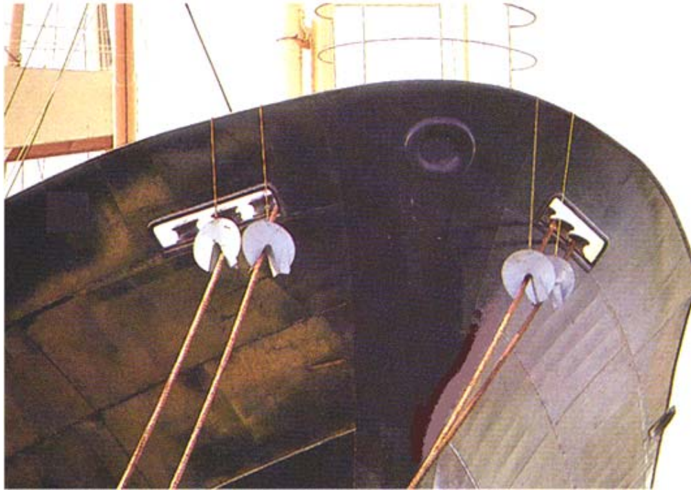
شکل ۲۸: نصب سپر فلزی به سیمها و طناب های کشتی با قطر حدود یک متر به عنوان مانع ورود موش
