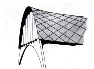
پوسته سهموی هذلولی که بر روی سخت کننده های انتهایی قرار دارد
