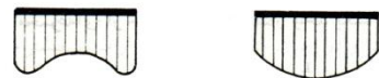
خاک چسبنده (Rigid wall) / خاک غیر چسبنده (Non-rigid wall) پی زیر سطح (Foundation below surface) / خطوط عمودی نشانگر شدت فشار تماس اند (Vertical lines indicate contact pressure intensity)
