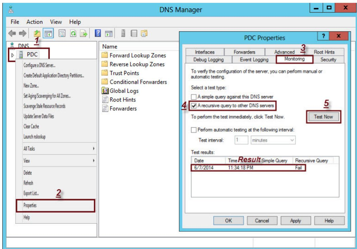
بعد از انجام تست اینکه آیا سرورها و کلاینت های شبکه داخلی به DNS سرورهای Public دسترسی دارند یا خیر، نوبت به این رسیده که این عمل را تسهیل کنیم، یعنی با وارد کردن بعضی از آدرسهای DNS سرورهای
