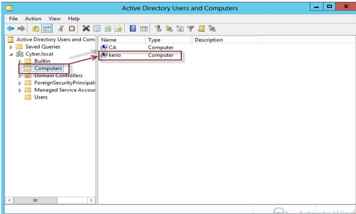
بعد از Join کردن Kerio Control به Domain نوبت به گرفتن Certificate از سایت CA برای Kerio Control می باشد، چونکه Certificate ای که در حال حاضر Kerio دارد بصورت Self Assign می باشد، یعنی خود Kerio به خودش Certificate داده است. برای این منظور از پنل مدیریتی Kerio Control وارد قسمت SSL Certificate می شویم، در پایین صفحه گزینه ای به نام Add وجود دارد که آن را کلیک می کنیم و بعد New Certificate Request را انتخاب می کنیم.
