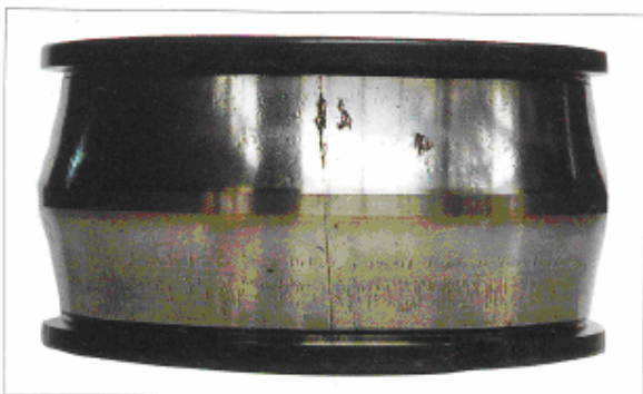
قطعه: کنس داخلی یک رولر برینگ بشکه ای نشانه: ترک هادریجت محوری روی سطح کنس علت: اعمال تنش های بیش از حد ناشی از اختلاف دمای زیاد بین شافت و کنس داخلی
