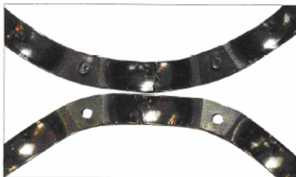
قطعه: قفسه یک بال برینگ شیار عمیق نشانه: شکسته شدن کیج استیل پرچ شده
