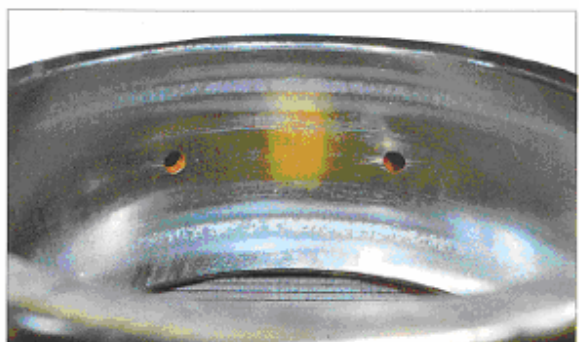
قطعه: کنس خارجی یک رولر برینگ بشکه ای نشانه: پوسته شدن در نزدیکی لبه کنس داخلی روی محیط کنس ایجاد شده است علت: روانکاری ناقص
