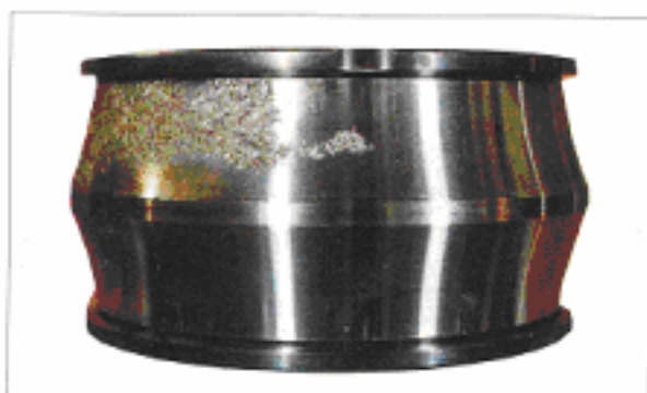
قطعه: کنس داخلی یک رولر بیرنگ بشکه ای نشانه: پوسته شدن تنهاریوی یکی ردیف از محل های عبور ساچمه ها علت: روغنکاری ناقص
