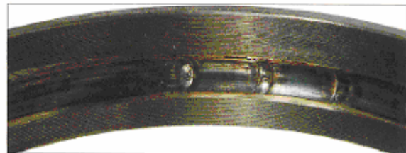
قطعه: کنس خارجی برینگ شکل قبل نشانه: کنس ها در قسمت حرکت ساچمه ها تغییر شکل می دهند و ذوب می شوند علت: زیاد بودن پیش بار
