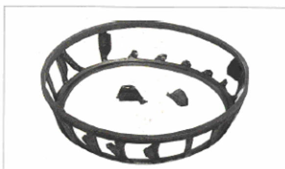
قطعه: قفسه یک رولر برینگ مخروطی نشانه: شکستگی ستون کیج
