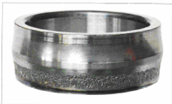
قطعه: کنس داخلی یک رولر بیرنگ بشکه ای نشانه: پوسته شدن تنهاریوی یکی ردیف از محل های عبور ساچمه ها علت: زیادبودن بار در جهت محوری
