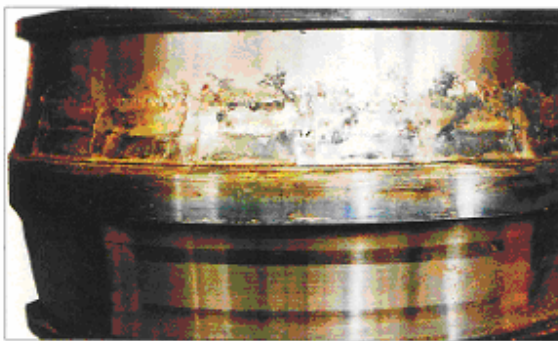
قطعه: کنس داخلی یک رولر برینگ بشکه ای نشانه: سطح کنس تغییر رنگ داده و ذوب شده است و ذرات فرسایشی قفسه و غلنگ ها به سطوح می چسبند علت: روغنکاری ناقص
