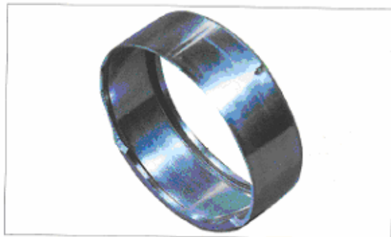
قطعه: کنس خارجی یک رولربرینگ سوزنی نشانه: شکستگی در لبه کنس خارجی اتفاق افتاده است علت: رولرها تحت بار زیاد قرار گرفته اند زیاد بودن بار یا غیریکنواخت اعمال شدن آن روی رولرها باعث شکسته شدن لبه هامی شود
