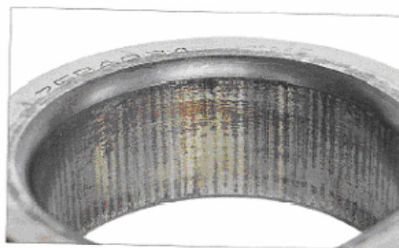
قطعه: کانس داخلی یک بال برینگ تماس زاویه ای نشانه: توجه شود که سایش در قسمت قطر داخلی سطح ایجاد شده است علت: ناکافی بودن انطباق
