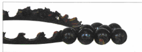
قطعه: ساچمه ها و قفسه برینگ شکل قبل نشانه: ذوب شدن قفسه تغییر رنگ و ذوب شدن ساچمه ها علت: زیاد بودن پیش بار
