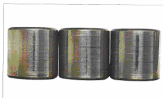
قطعه: رولرهای یک رولر برینگ استوانه ای نشانه: سختی کاذب روی سطوح اتفاق می افتد علت: لرزش از منبع خارجی در حالت سکون
