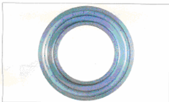
قطعه کنس خارجی یک بال برینگ تراست نشانه: سختی کاذب روی سطوح اتفاق می افتد علت: ارتعاشات مکرر بادامنه کم
