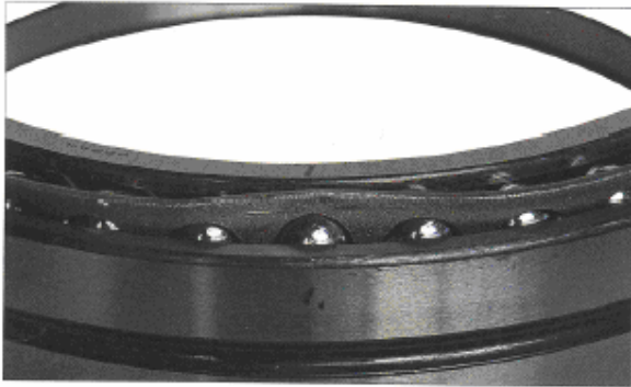
قطعه: قفسه یک بال برینگ تماس زاویه ای نشانه: تغییر شکل دادن کیج پریس شده فولادی علت: بار ضربه ای ناشی از حمل و نقل غلط
