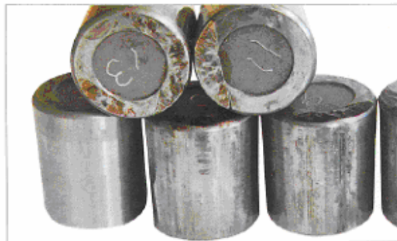
قطعه: رولر مربوط به برینگ شکل قبلی نشانه: فرسایش پله ای شکل روی سطح بالایی رولر علت: توسعه سایش ناشی از بار زیاد روی برینگ در حالت سکون است
