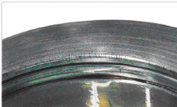
قطعه: کنس خارجی یک رولبرینگ استوانه ای دوردیفه نشانه: ترک های حرارتی روی سطح بیرونی رولرها اتفاق افتاده علت: تولید گرمای غیرعادی ناشی از لغزش تماسی بین رولرها و سطح کنس خارجی
