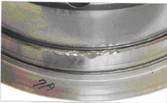
قطعه: کنس داخلی یک رولربرینگ دوردیفه استوانه ای نشانه: شکستگی در وسط اتفاق افتاده علت: اعمال نیروی اضافی هنگام نصب
