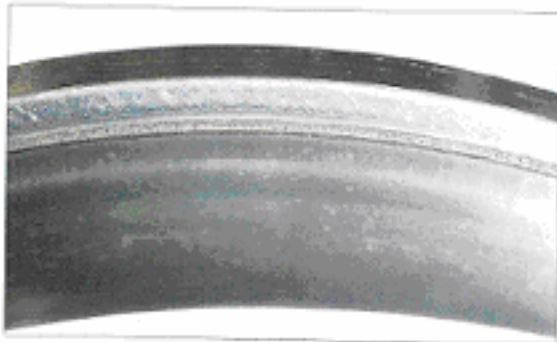
قطعه: کنس داخلی یک رولر پرینگ پنسکه ای نشانه: خط افتادن روی کنس داخلی بصورت شیاری علت: تغییرات شتاب ناگهانی
