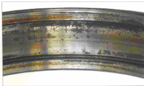
قطعه: کنس خارجی یک رولربرینگ مخروطی نشانه: زنگ زدگی روی سطح لبه ها و محل ساچمه ها علت: نقصان روغنکاری ناشی از ورود آب
