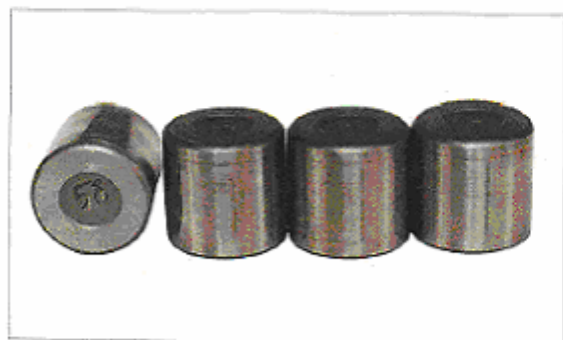
قطعه: رولرهای یک رولربرینگ استوانه ای نشانه: خراش های طولی درداخل کنس علت: گج جارتن کنس هاهنگام نصب
