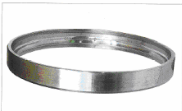
قطعه: کنس خارجی شکل قبلی نشانه: پوسته شدن در محل شیار دایره گام ساچمه ها علت: فرورفتگی ناشی از لرزش در حالت استاتیکی
