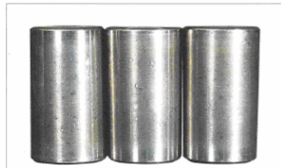
قطعه: رولرهای برینگ شکل قبلی نشانه: تورفتگی ریز و درشت روی تمامی سطوح داخلی علت: گیر افتادن ذرات بین سطوح
