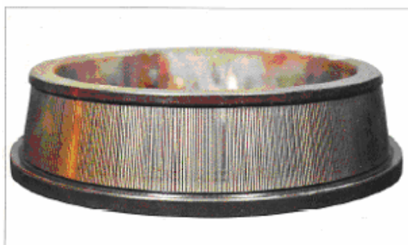
قطعه: کنس داخلی یک رولر برینگ مخروطی نشانه: خوردگی بصورت خط های موازی روی سطح کنس مشاهده می شود
