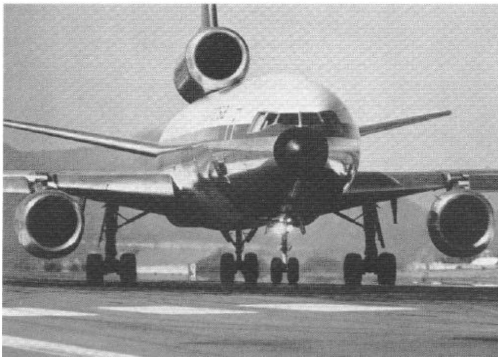
شکل ۱۹-۱ McDonnell Douglas DC-10 با سه توربوفن CF6 نسبت کنارگذاری بالا ساخت شرکت General Electric
