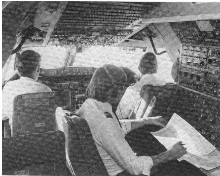
شکل ۹-۱۴ در زمان اتاق های خلبانی سه نفره ، این وظیفه ی مهندس پرواز بود تا سیستم های موتور و سوخت را ملاحظه کند (بوینگ قدیمی ۷۴۷)
