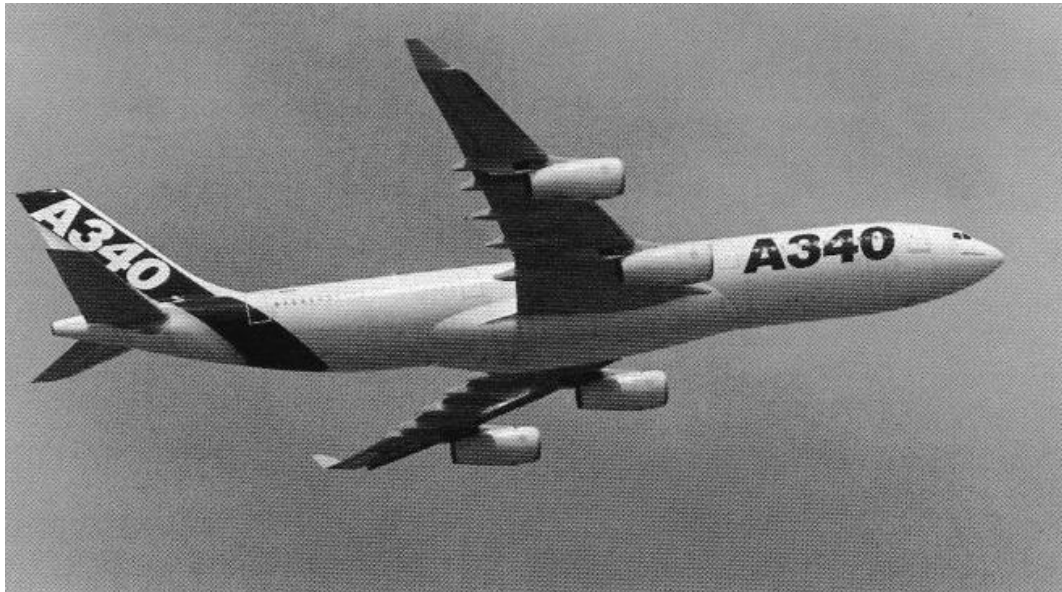
شکل ۱-۱۱ آرایش موتور زیر بال (Airbus A340)
