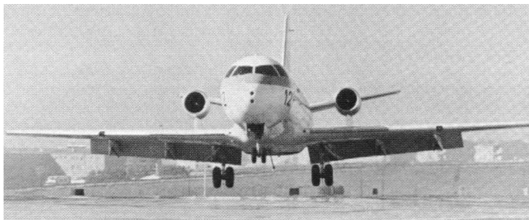
شکل ۱۱-۶ اولین هواپیما دارای نصب بالای بال (VFW-Fokker 614 در دهه ی شصت)
