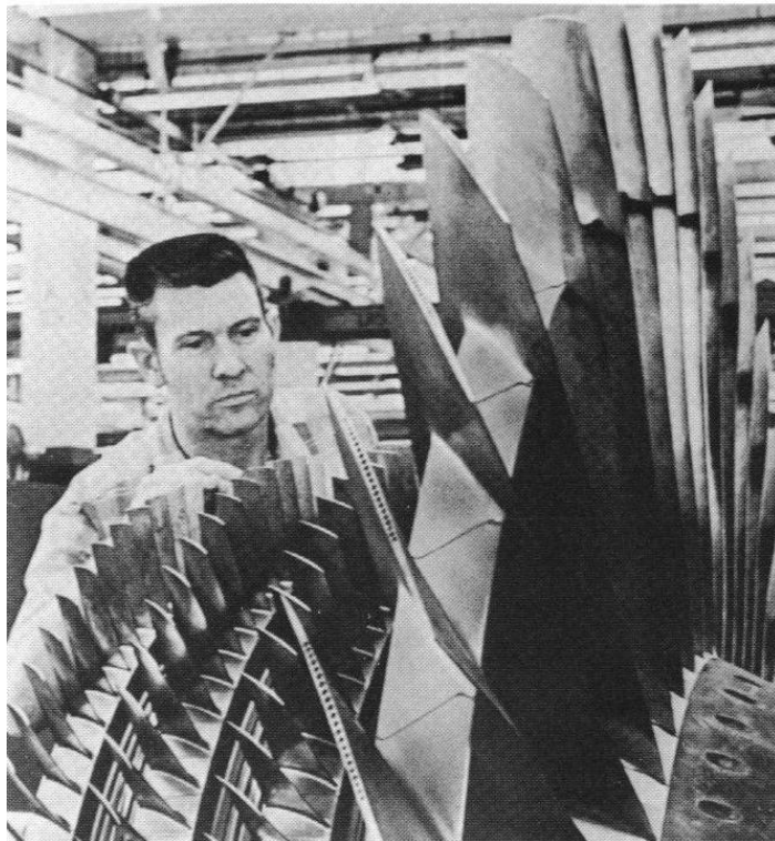
شکل ۴۲۸ شکل مقطع آیرودینامیکی کمانی معمولی از بخش بالایی پره های فن. این فن در سرعت سوپرسونیک فعالیت می کند. برای کاهش وزن، هر پره ۲۲ سوراخ دارد. پشت فن یک تقویت کننده ی سه مرحله ای قرار دارد تا فشار جریان موتور هسته را بالا ببرد (CF6 6 ژنرال الکتریک)
