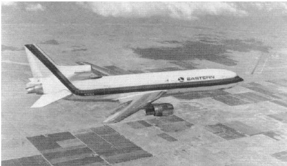
شکل ۱-۱۸ Lockheed TriStar ۱۰۱ با سه توربوفن RB211 با نسبت کنار گذاری بالا ساخت شرکت رولزرویس
