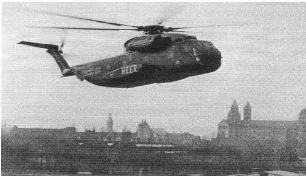
شکل ۲۱-۱ هلیکوپتر Sikorsky CH-53G با دو موتور توربوشفت T64 ساخت شرکت General Electric.
