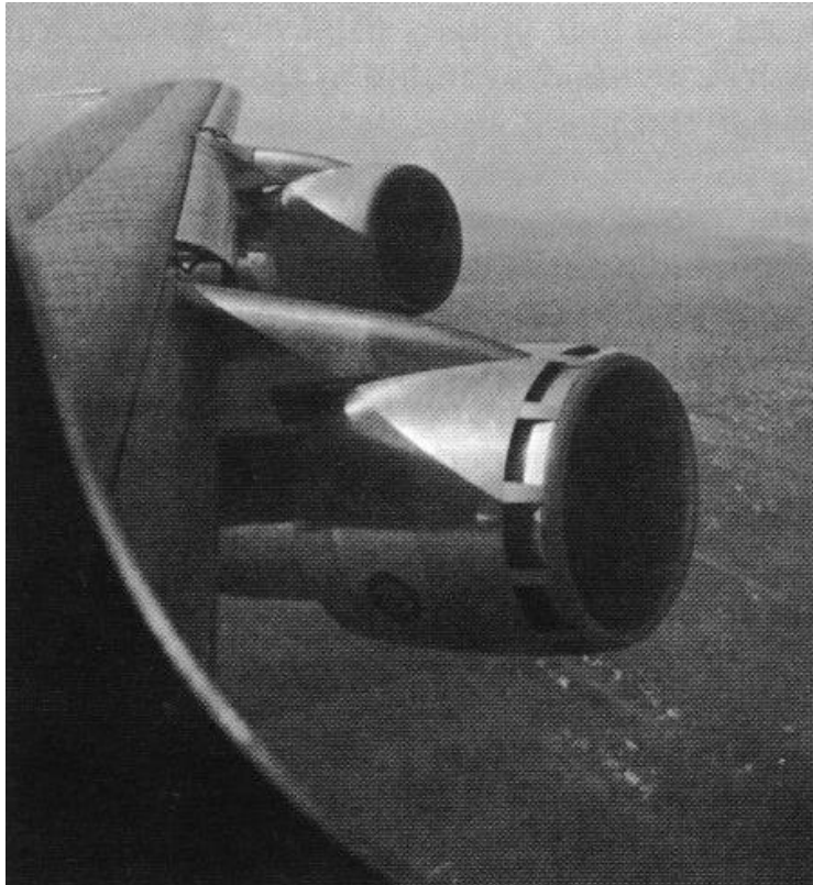
شکل ۶-۱۰ توربوفن های ابتدایی نسبت کنار گذاری بالا، با ویژگی درب های ورودی محوری که سر و صدا توربومشین را عبور می دهد. موتور خارجی تازه طراحی شده بدون درب ها، حال در تمام هواپیما های ترابری ساب سونیک رایج شده است (آزمایش پرواز بوئینگ ۷۴۷)
