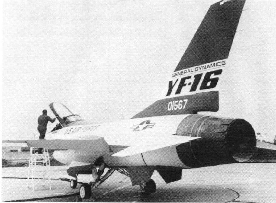
شکل ۱۵-۱۱ پیکر بندی ها با بال عمودی واحد دارای پسای کم تری است
