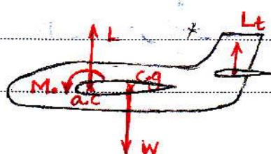
$$\text{بالانس کردن طولی حرایا} \quad \sum M = 0 \quad L_{WB} + L_t = W$$
