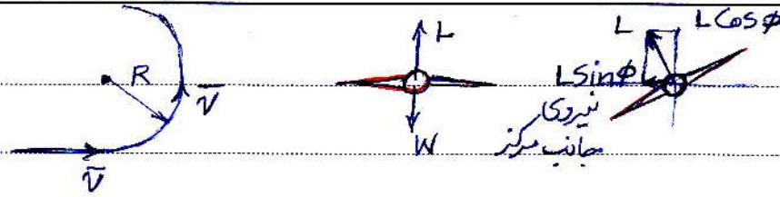
$$\begin{pmatrix} x_b \\ y_b \\ z_b \end{pmatrix} = \begin{pmatrix} 1 & 0 & 0 \\ 0 & \cos\phi & \sin\phi \\ 0 & -\sin\phi & \cos\phi \end{pmatrix} \begin{pmatrix} x_r \\ y_r \\ z_r \end{pmatrix}$$
