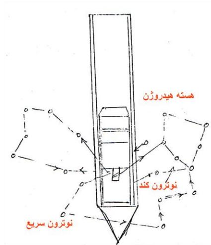
(e) اندازه گیری میزان رطوبت و دانسیته دستگاههای اندازه گیری میزان رطوبت و دانسیته بطور روز افزونی در ساختمانها، معادن ، صنایع و بررسیهای زمین شناسی و خاکشناسی مورد استفاده قرار می گیرد
