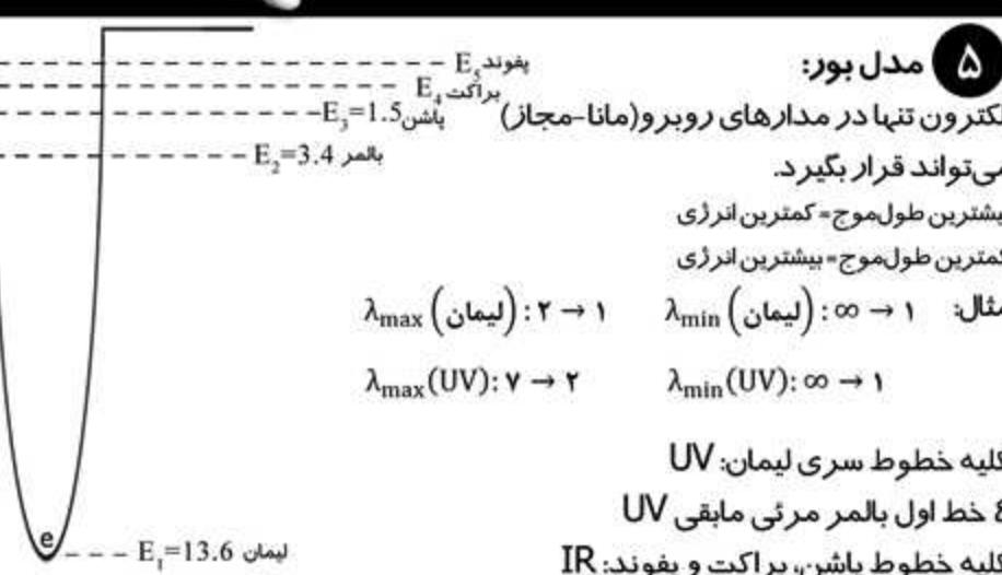
۵ مدل بور: الکترون تنها در مدارهای روبرو (مانا-مجاز) باشد. باقی طول موج = پیشترین انرژی کمترین طول موج = پیشترین انرژی کمترین طول موج = مقدار ثابت:
