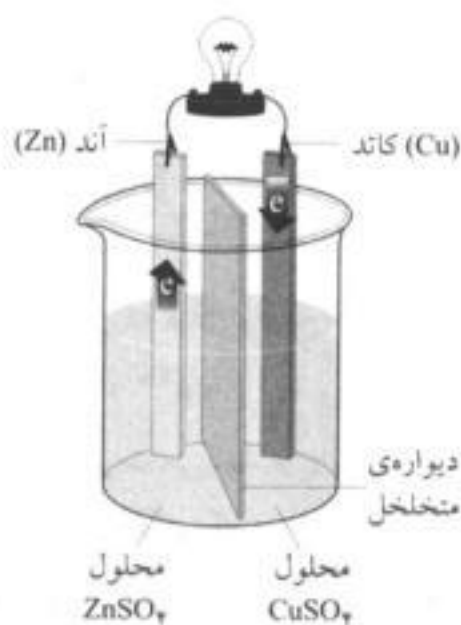
شکل (۱۵) - استفاده از دیواره‌ی متخلخل در سلول الکتروشیمیایی گالوانی
