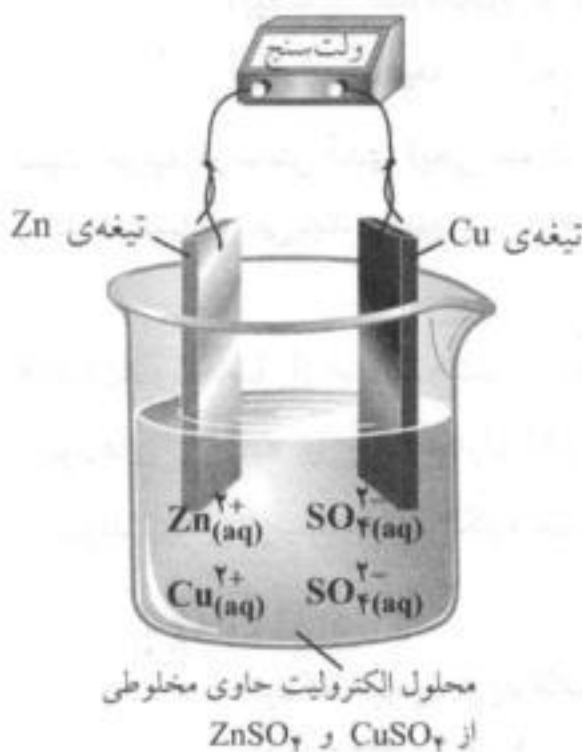
شکل (۱۴) - سلول الکتروشیمیایی «Zn - Cu» بدون دیواره‌ی متخلخل
