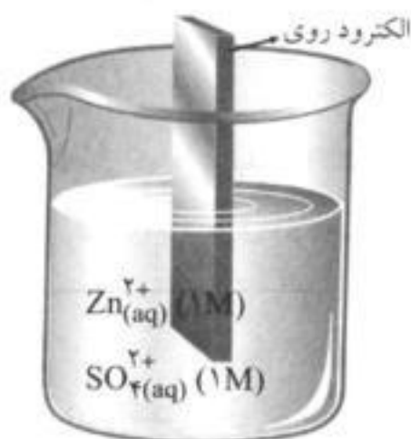
شکل (۲) - نیم سلول استاندارد روی
