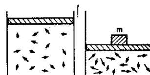
اتمهای گاز در دو حالت تحرکی متفاوت. افزایش فشار تحرک اتمها را بیشتر می‌کند.
