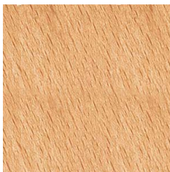
شکل ۲-۳: برش شعاعی نشان دهنده پرمگس‌ها در گونه راش می‌باشد.
