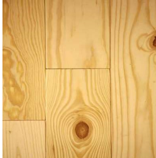
شکل ۲-۶: شمایی از چوب کاج، در این شکل وجود گره‌ها کاملاً مشخص می‌باشد.
