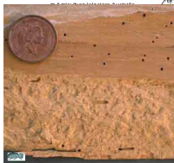
شکل ۵-۵: لارو، سوسک و نمونه سوراخ کردن چوب توسط سوسک لیکتوس.
