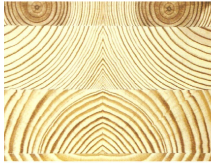
شکل ۱-۴: تنوع حلقه‌های رویش و تمایز چوب آغاز و پایان در گونه کاج جنوبی.
