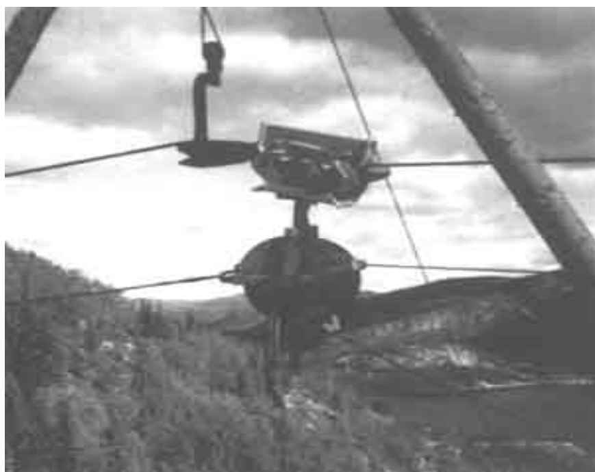
شکل ۲۲- تصویری از یک قرقره حمل کننده چوب در سیستم های انتقال چوب
