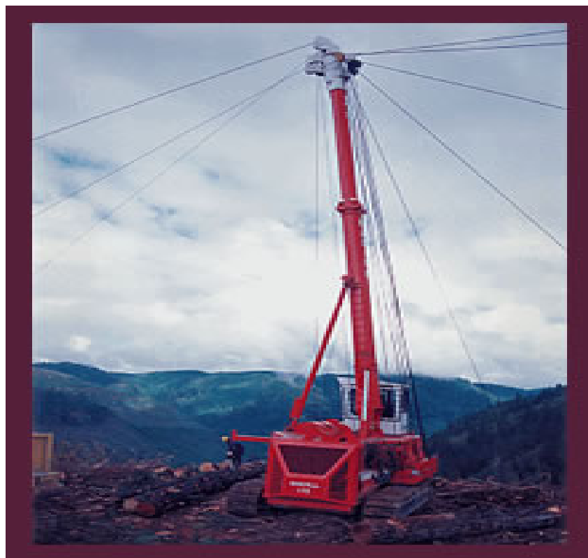
شکل ۲۱- یک دکل سیستم کابل همگانی که از نزدیک قابل مشاهده می باشد
