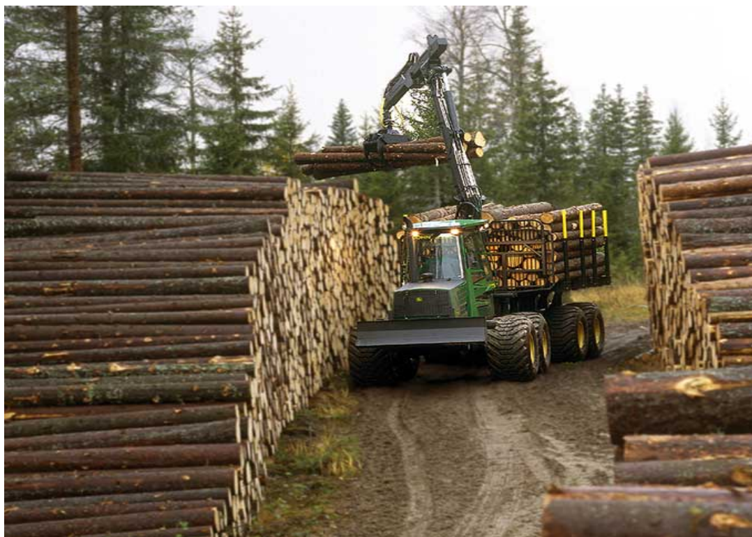
شکل ۳۴- اجرای عملیات فورواردینگ در دیوی چوب
