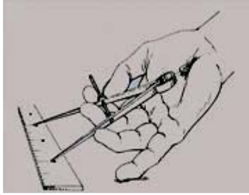
شکل ۴-۲. چگونگی تنظیم پرگار تقسیم
