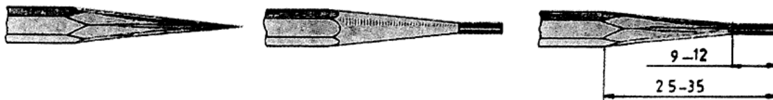
شکل 2-3. مشخصات قسمت تراشیده شده‌ی مداد
