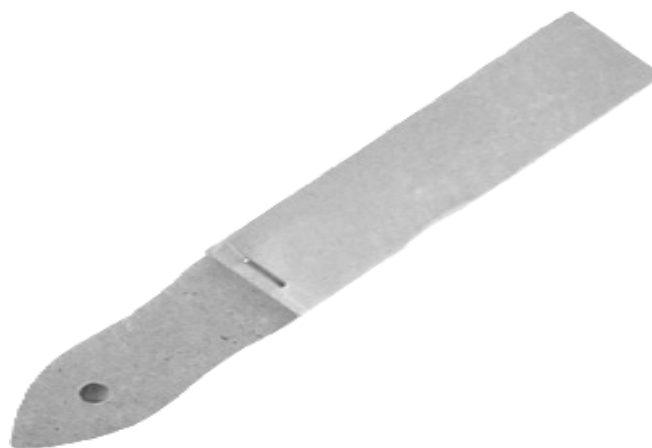
شکل 2-5. کاغذ سنباده نصب شده بر روی یک تکه چوب
