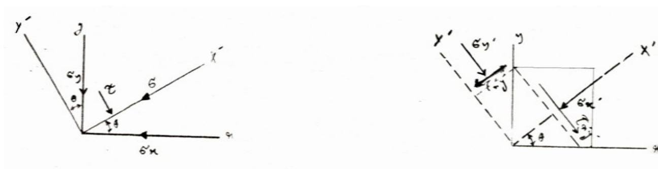
شکل ۲-۸- بدست آوردن تنش قائم و برشی به روش دوران محور ها
