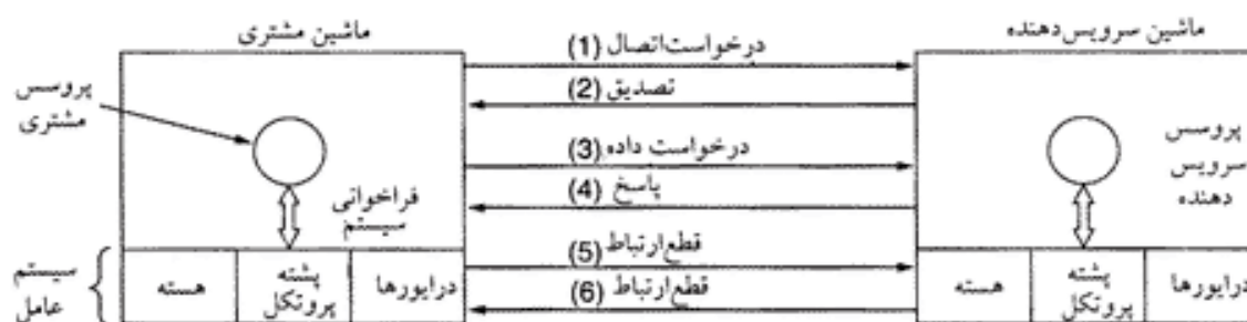
شکل ۱-۱۸. تبادل بسته ها در یک شبکه اتصال-گرای مشتری-سرویس دهنده.
