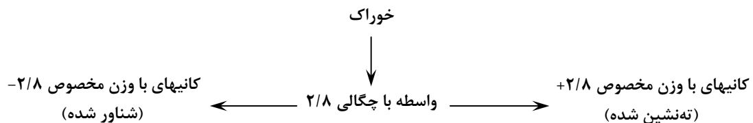
شکل ۱-۱۴- اصول جدایش توسط واسطه‌های سنگین
