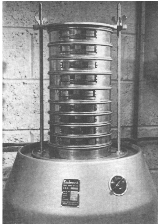
شکل ۶-۱- سرند لرزاننده با ۵ سرند بزرگ و ۴ سرند کوچک
