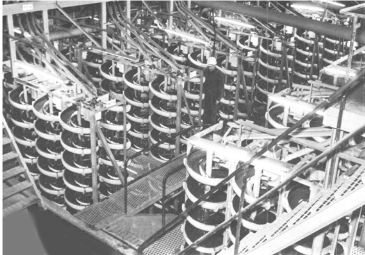
شکل ۱۳-۱۲- مجموعه‌ای از جدا کننده‌های مارپیچی Humphrey
