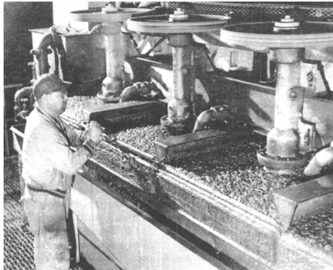
شکل ۱۱-۱۹- سلولهای فلوتاسیون مکانیکی قدیمی با حجم 5/7m^3
