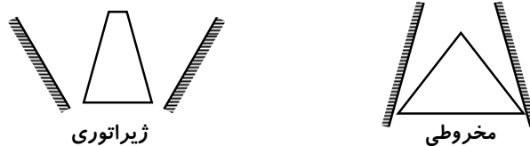
شکل ۸-۸- تفاوت بین سنگ شکن مخروطی و ژیراتوری
