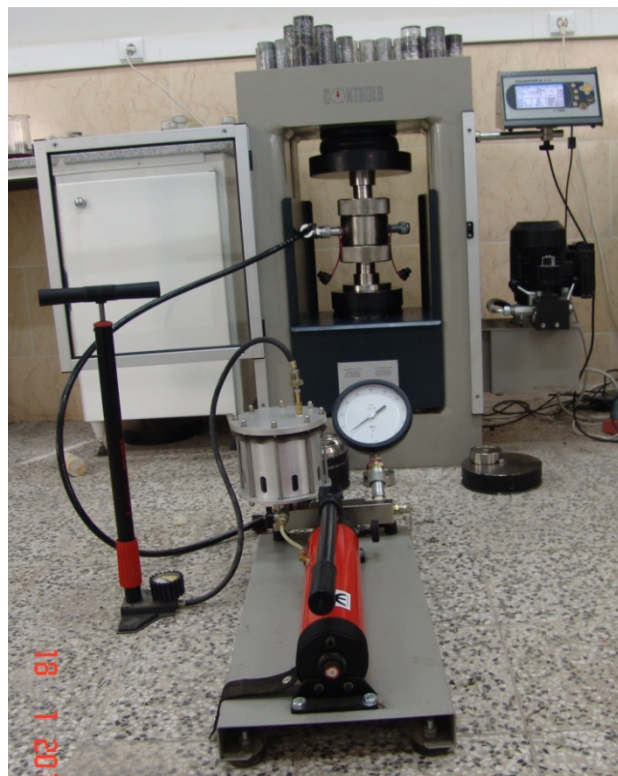
شکل ۱۰-۲- نمای کلی دستگاه آزمایش مقاومت فشاری
