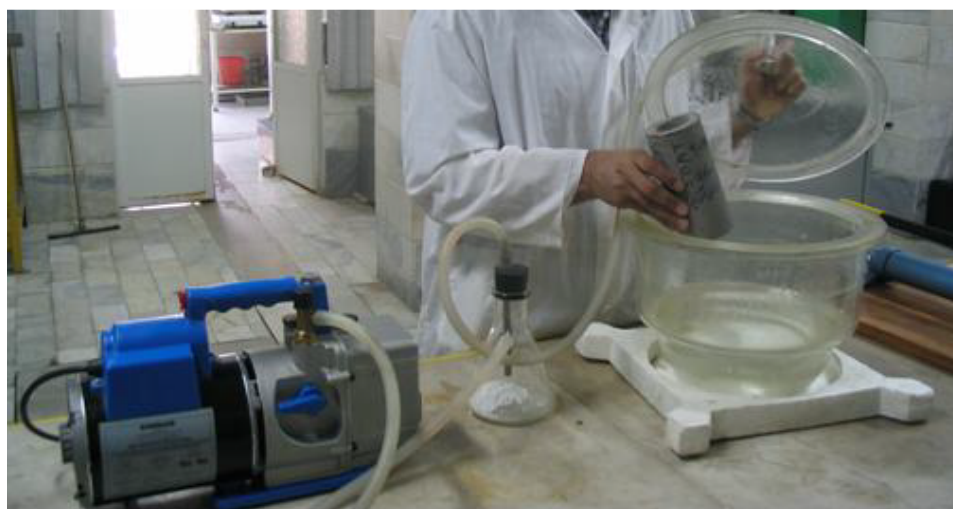
شکل ۲-۱ دسیکاتور به همراه پمپ خلا
