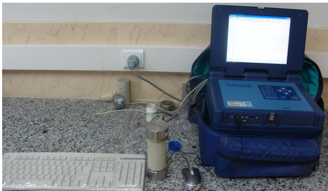
شکل ۵-۱- دستگاه اندازه‌گیری سرعت امواج صوتی در سنگ
