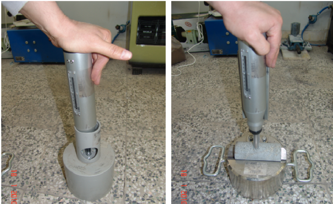
شکل ۶-۱- چکش اشمیت به همراه سندان کالیبراسیون
