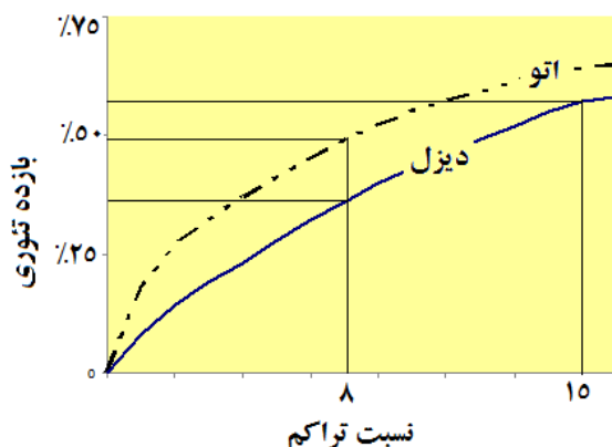
شکل ۳-۶ بازده تئوری چرخه اتو و دیزل
