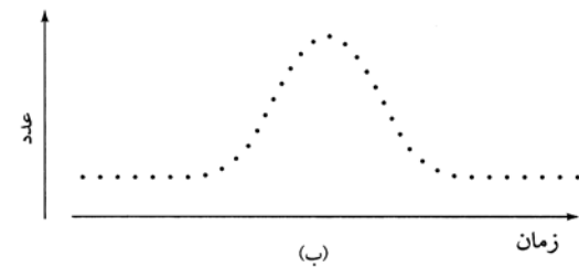
شکل ۱-۱ تغییرات جوابهای آشکار ساز نسبت به زمان سیگنالهای یکسان (الف): در حوزه آنالوک، (ب): در حوزه دیجیتال
