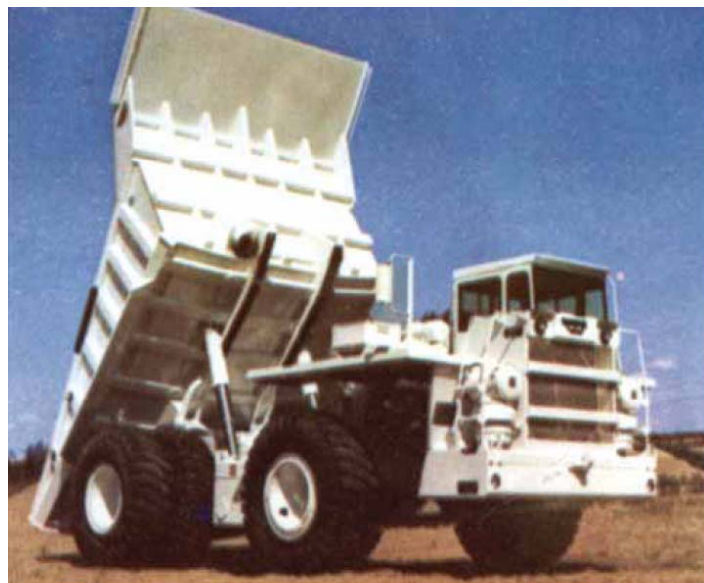
یک نوع کامیون معدنی تخلیه شونده از پشت
