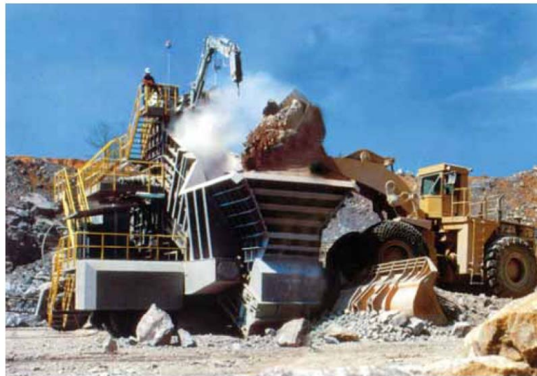
لودر در حال بارگیری سنگ شکن معدن
