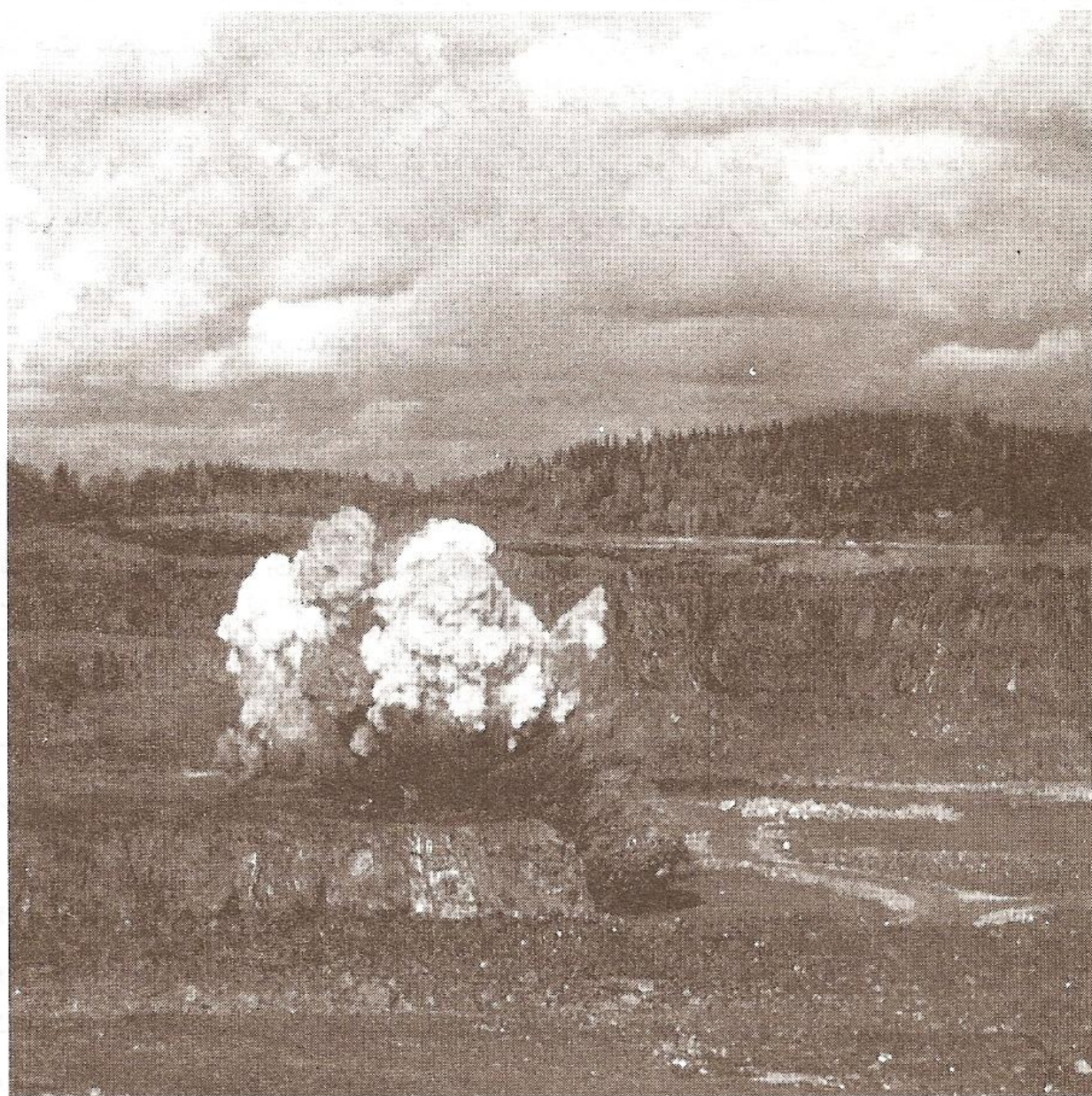
شکل ۵۸ - همزمان با افزایش تعداد ردیفها، حرکت سنگ به جهت عمودی متمایل خواهد شد.
