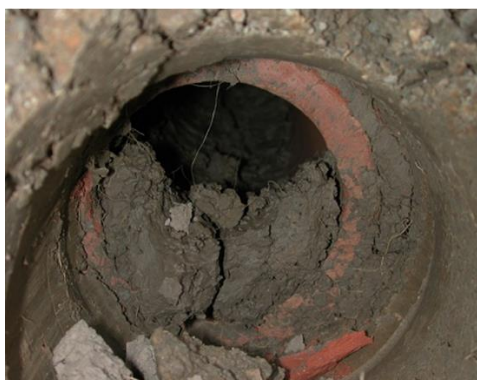
شکل ۲-۴۴: تاثیر قطر لوله‌های انتقال پالپ در ته‌نشین شدن ذرات
