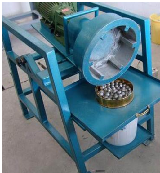
شکل ۹-۱: آسیای آزمایشگاهی مربوط به آزمایش تعیین شاخص سختی سنگ معدن (SPI)
