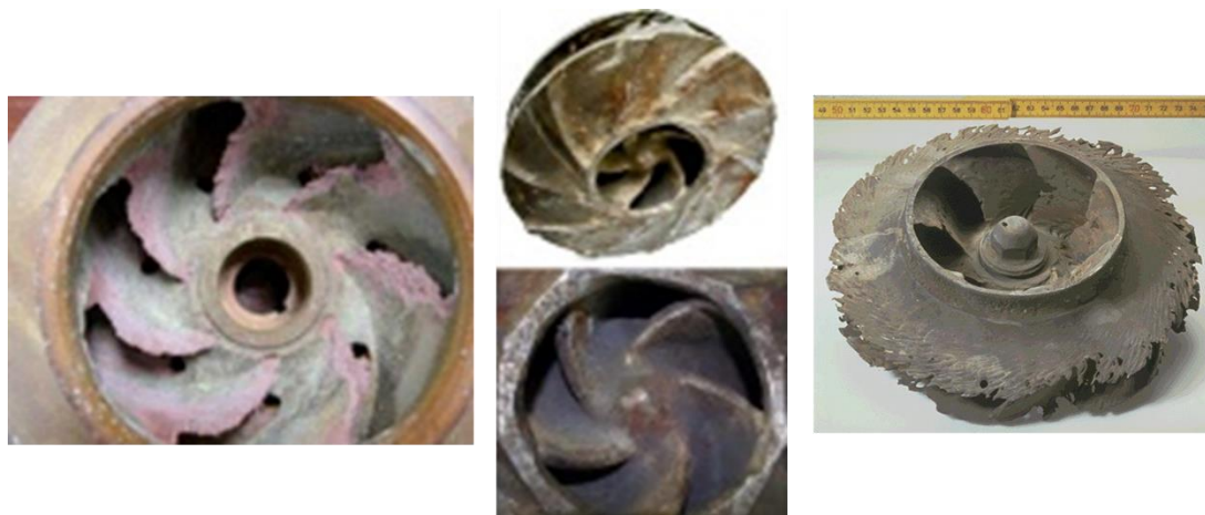
شکل ۲-۴۳: سایش در قطعات مربوط به پمپ ها
