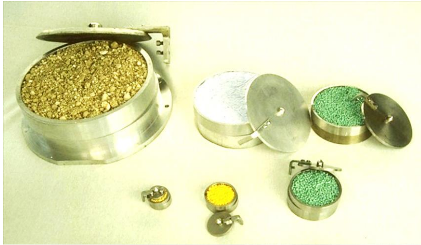
شکل ۶-۴: سلول برشی مربوط به آزمایش تعیین تنش برشی برای مواد دانه ای
