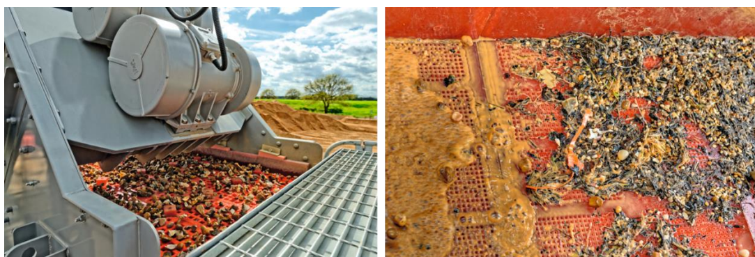
شکل ۱-۱۷: ذرات چوب و زباله که باعث گرفتگی چشمه‌های سرنده شده است.
