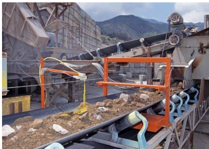
شکل ۱-۲۴: پاشش رنگ در محلی که فلز تشخیص داده شده است.
