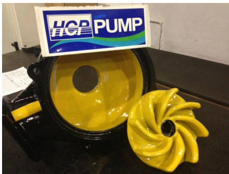
شکل ۷-۴: استفاده از آسترای قابل تعویض برای کاهش سایش در پمپ های انتقال مواد
