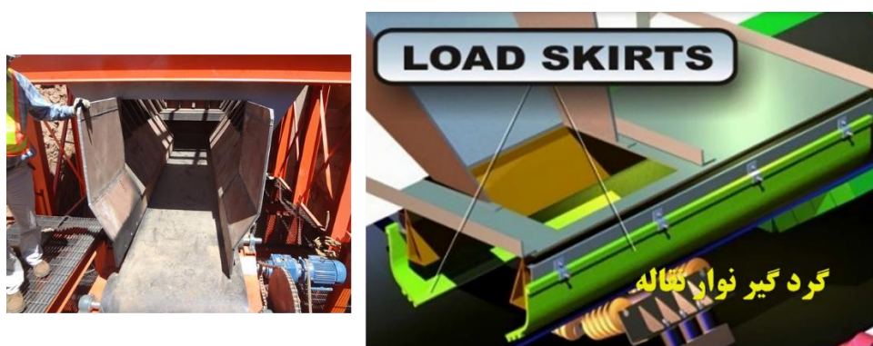
شکل ۲-۲۴: صفحات هدایت گر مواد و گردگیر روی نوار نقاله
