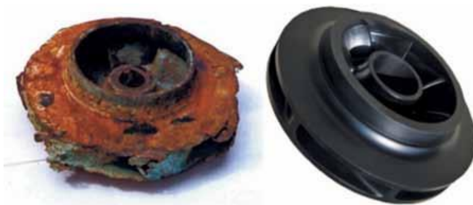
شکل ۷-۳: سایش در پمپ های انتقال مواد
