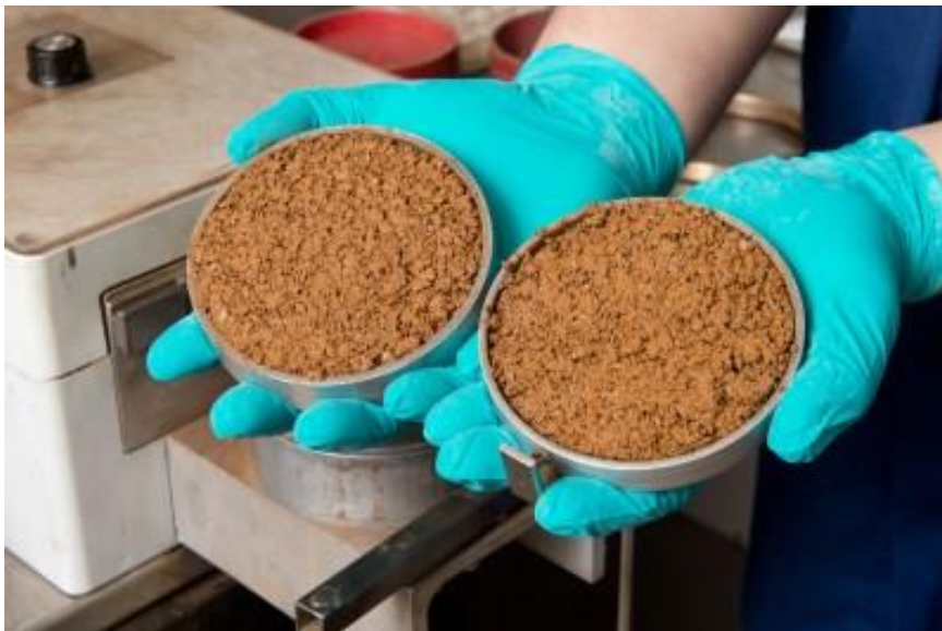
شکل ۶-۱۱: سلول برشی و مواد تحت برش پس از انجام آزمایش
