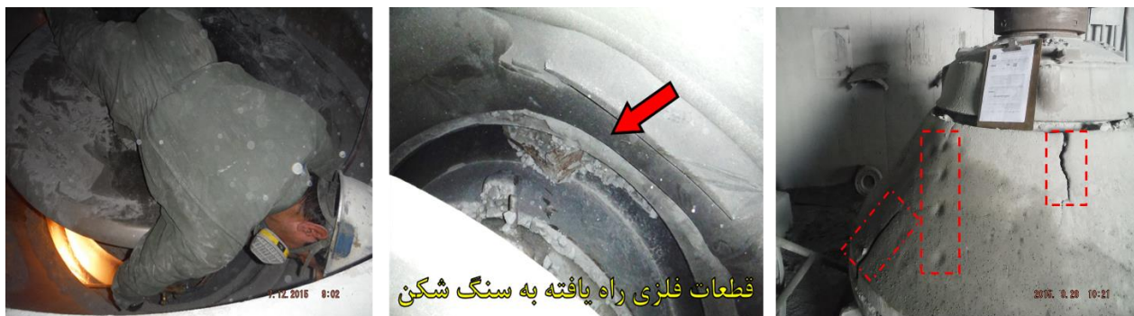
شکل ۱-۱۹: صدمه قطعات فلزی در داخل سنگ شکن
