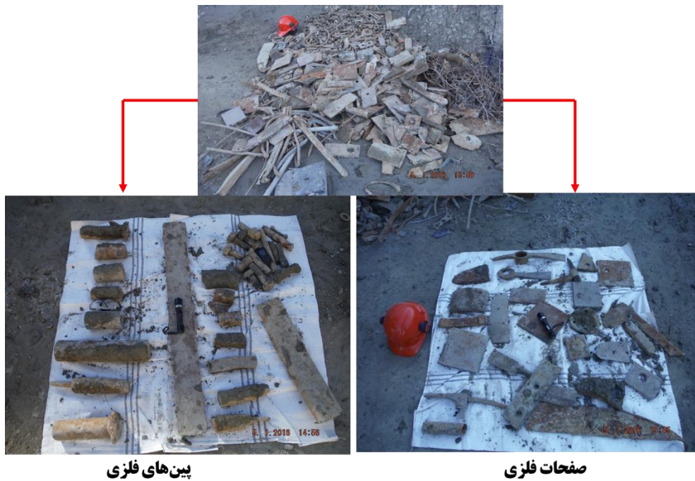
شکل ۱-۱۸: قطعات فلزی با احتمال بالای متوقف کردن سنگ شکن
