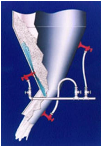
شکل ۴-۵۱: مهیا کردن سیستم بستر سیال در مخزن
