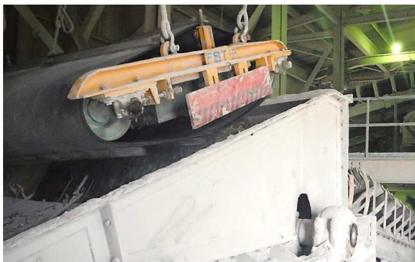
شکل ۱-۲۳: قرارگیری جدا کننده مغناطیسی در محل ریزش بار
