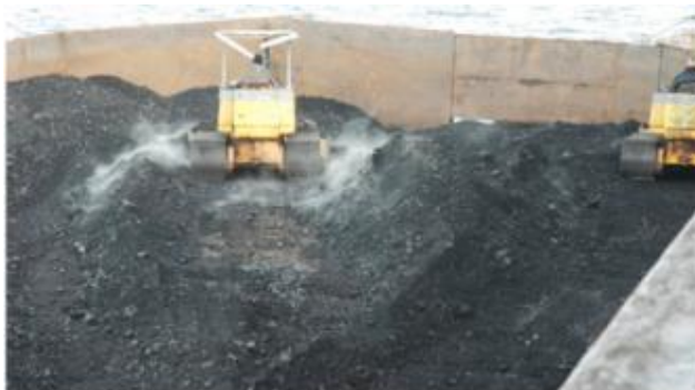
شکل ۳-۲۸: ریختن پودر بر روی ذغال‌ها برای جلوگیری از اکسیداسیون
