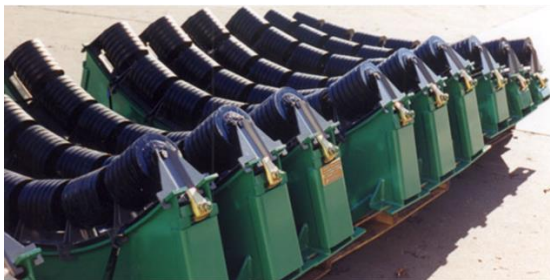
شکل ۲-۲۲: افزایش تعداد هرزگردهای زیر خوراک دهنده برای محافظت از نوار
