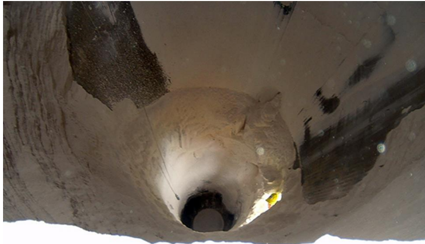
شکل ۴-۴۱: چسبیدن مواد به زائده ها
