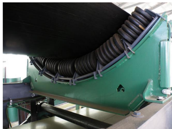
شکل ۲-۲۲: افزایش تعداد هرزگردهای زیر خوراک دهنده برای محافظت از نوار
