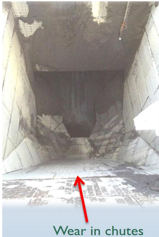
شکل ۴-۴۲: سایش در بدنه مخازن
