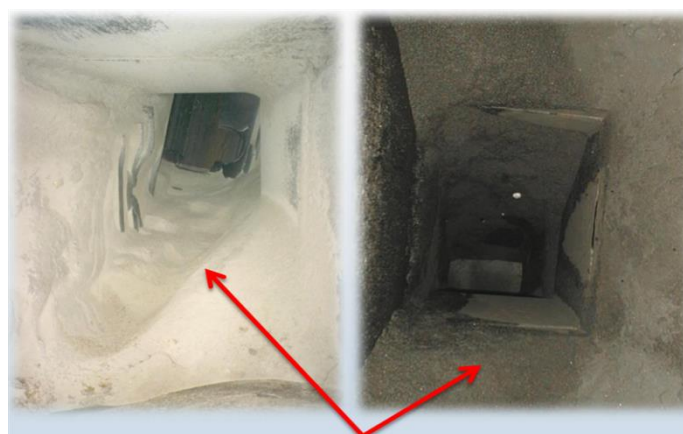
شکل ۴-۴۴: در صورتی که سطح داخلی قیف صاف نباشد
