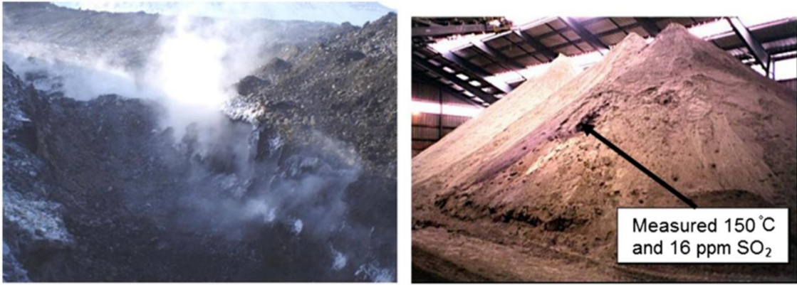
شکل ۳-۲۶: خود گرم شدن (Self-Heating)
