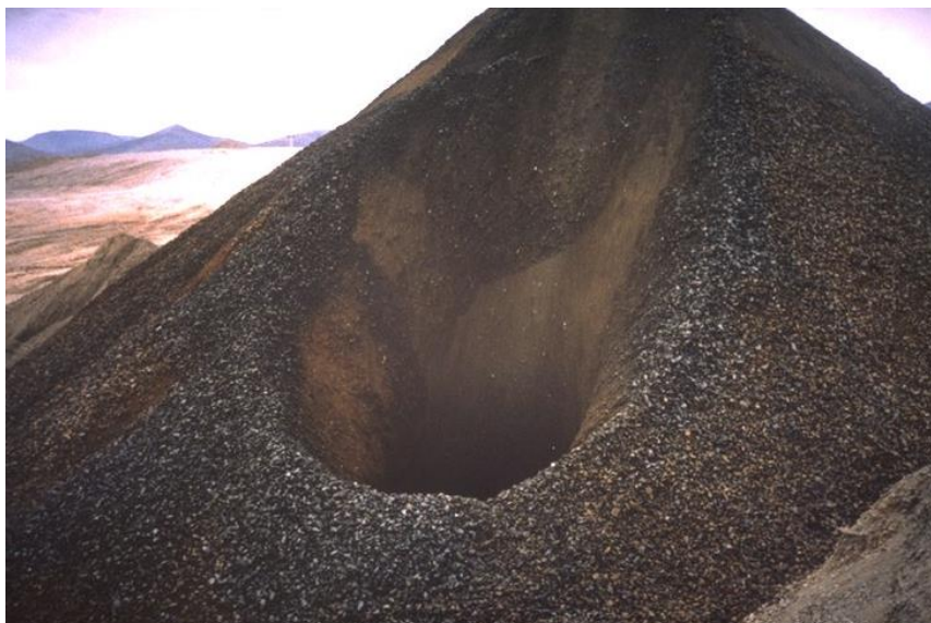
شکل ۶-۱: لوله ای شدن در یک مخزن روباز
