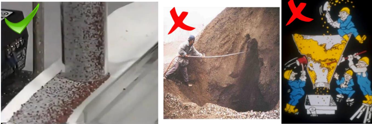
شکل ۴-۴: خارج کردن محتوی مخزن بطور اطمینان بخش در زمان تقاضا
