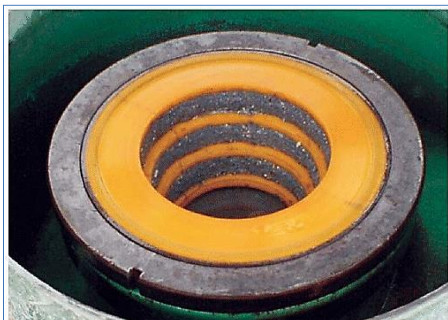
شکل ۳-۴۴- نمایی از کنسانتره تولید شده در پایان عملیات در جدا کننده نلسون
