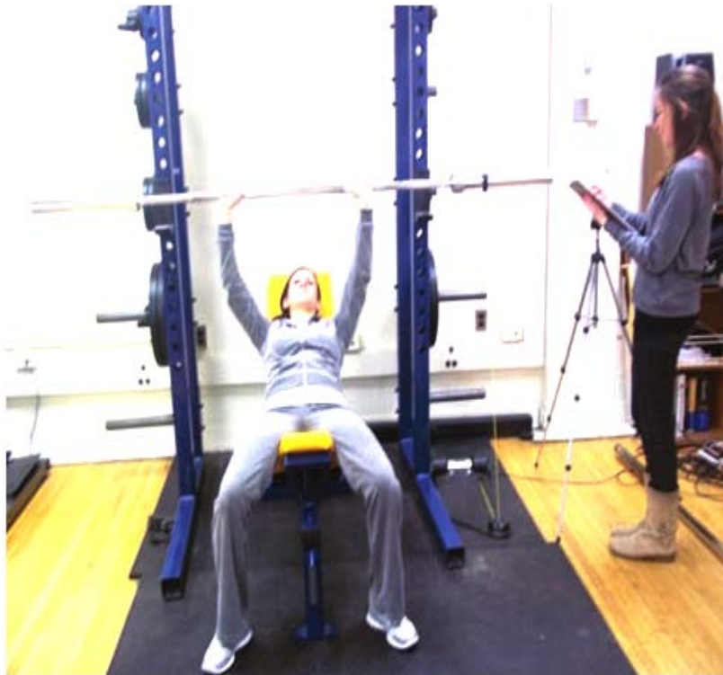
شکل ۳-۶ مبدل نیروسنج در حرکت پرس سینه شیب دار
