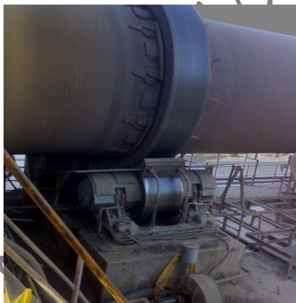
شکل شماره ۵: رینگ و غلطک های کوره
