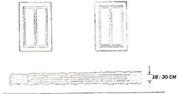
ایجاد مانع در تمام ضخامت دیوار از طریق لایه های افقی از ماده ای غیر جاذب
