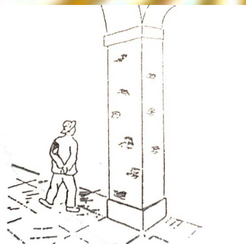
لکه های مجزا و پراکنده اینجا و آنجا و در هر ارتفاعی و با رنگ بندی متفاوت نشانه رطوبت متغیر است
