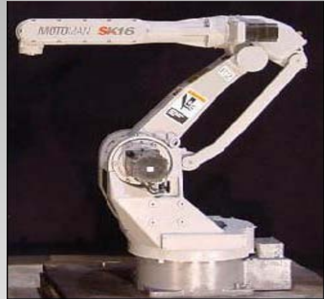
Fig. 1.7 The Motoman SK16 manipulator. با پیوند متوازی الاضلاع
