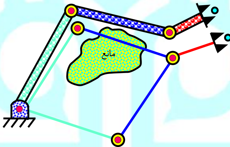
شکل (۳): یکی از دو راه حل ممکن برای رسیدن به نقطه B ، باعث برخورد بازو به مانع می‌شود.
