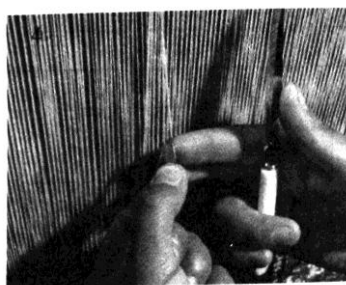
شکل شماره ۵۱- نحوه گره زدن خامه به روش فارسی
