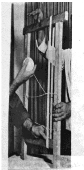
شکل شماره ۳۵. چله کشی به روش ترکی بر روی دار قالی
