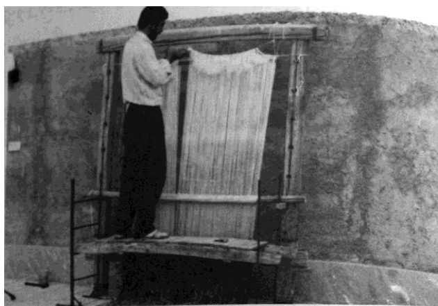
شکل شماره ۴۱- روش نصب چله دوانده شده بر روی سردار
