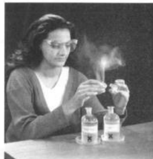
شکل (۱۱) - واکنش گاز هیدروژن کلرید با گاز آمونیاک که منجر به تشکیل جامد یونی سفیدرنگی می‌شود.
