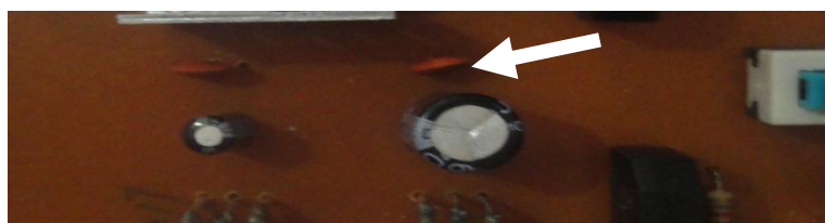
شکل ۱۰-۲ حذف نویز از مدار
