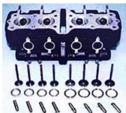
سریلندرها از جنس آلومینیوم و یا چدن هستند که امروزه از آلومینیوم استفاده می شود چون تبادل حرارتی بیشتری دارند در سرسیلندرها سوپاپ هوا از سوپاپ دود بزرگتر است بدلیل بالا بردن راندمان حجمی موتور است.
