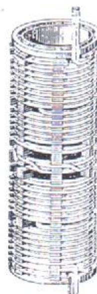
سیم‌بج ساده مارپیچی با سه جابجائی (ترانسپوزه)
