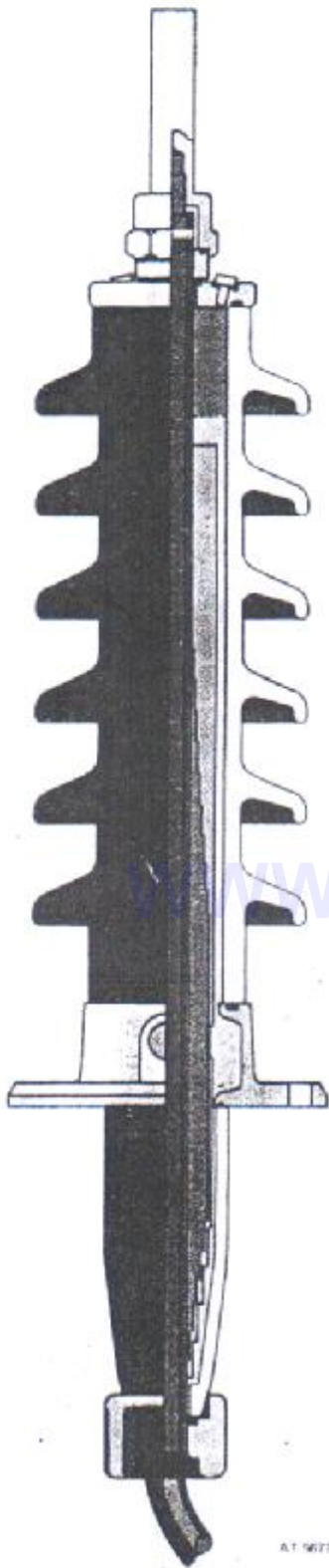
مقطع بوشینگ ترانسفورماتور نوع (ASEA) GOB
