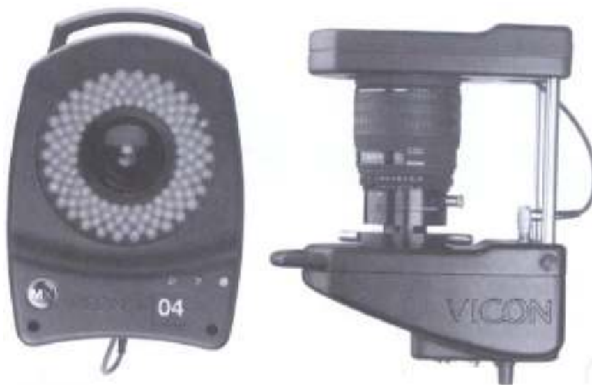
شکل ۱-۴. دوربین ویدیویی دیجیتال مجهز به دی یو‌دهای ساطع کننده‌ی نور قرمز مرئی که برای ضبط ویدیویی سه بعدی حرکت مورد استفاده قرار گرفته است. (با اجازه‌ی Vicon Peak Limited ).
