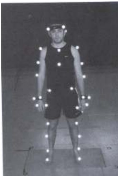
شکل ۱-۳. فرد نشاندار شده با نشانگرهای بازتابی در آزمایشگاه در احاطه‌ی سیستم تحلیل حرکت سه بعدی. (با اجازه‌ی دانشگاه Wales Swansea).
