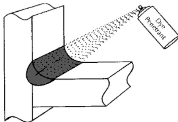
نت مایع نافذ، یکی از روش‌های آزمایش غیر مخرب است که موجب آشکارسازی عیوب سطحی می شود و لذا نت مایع نافذ روشی است که در جهت پیدا کردن ناپیوستگی های سطحی به کار برده می شود. عموما همه مواد (به جز مواد با سطح متخلخل) را می توان به وسیله این روش و به طور معمول نت نمود
