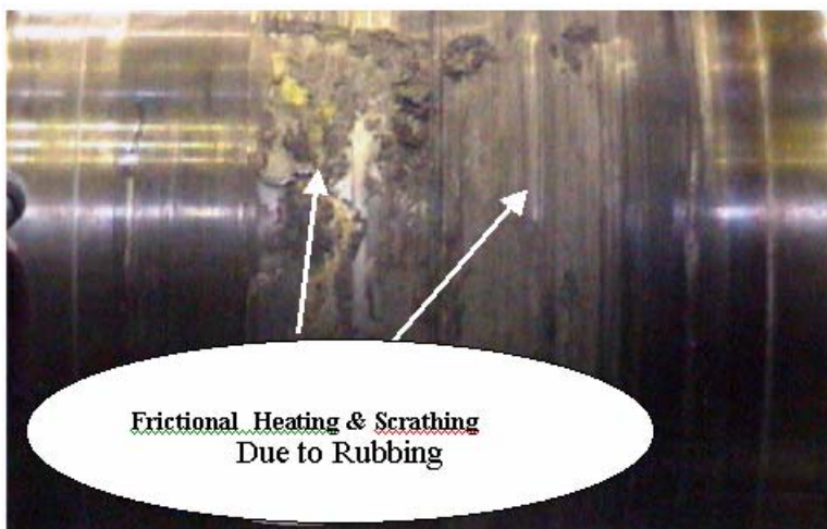
شکل ۲: حضور اثرات ناشی از ایجاد اصطکاک/سایش شدید بین ژورنال و یاتاقان
