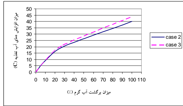
شکل (۱۰) میزان افزایش دمای آب ورودی بر حسب درصد برگشت آب گرم به ورودی پیش گرمکن
