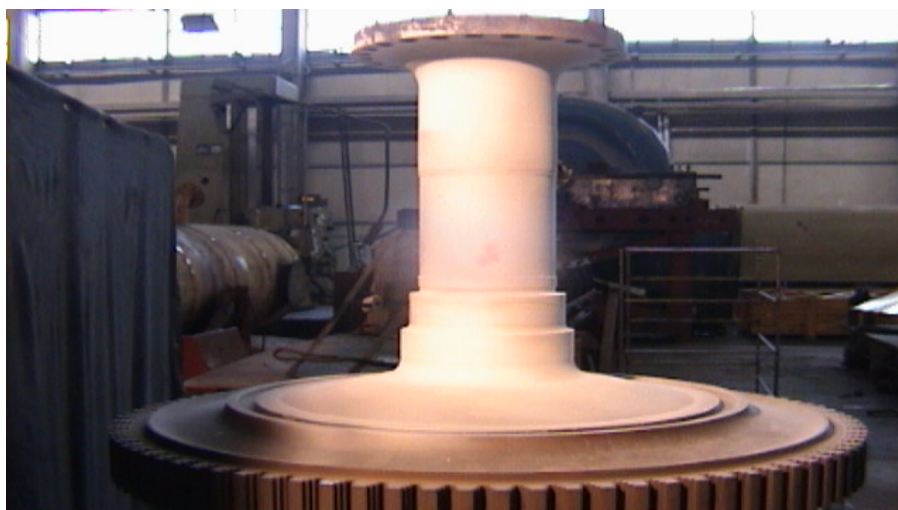
شکل ۷: پاشش محلول کربنات کلسیم به منظور جلوگیری از رخدادهای اکسیداسیون
