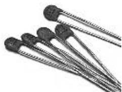
در این مدار به نوع خازنها توجه کنید. سه نوع خازن مولتی لایر ، الکترولیت و سرامیکی مورد استفاده قرار گرفته است. همانطور که در نقشه ملاحظه می کنید.، این خازنها با حروف اولشان مشخص هستند. C. نمایانگر خازن سرامیکی ، m نمایانگر خازن مولتی لایر و E نمایانگر خازن الکترولیت است .
