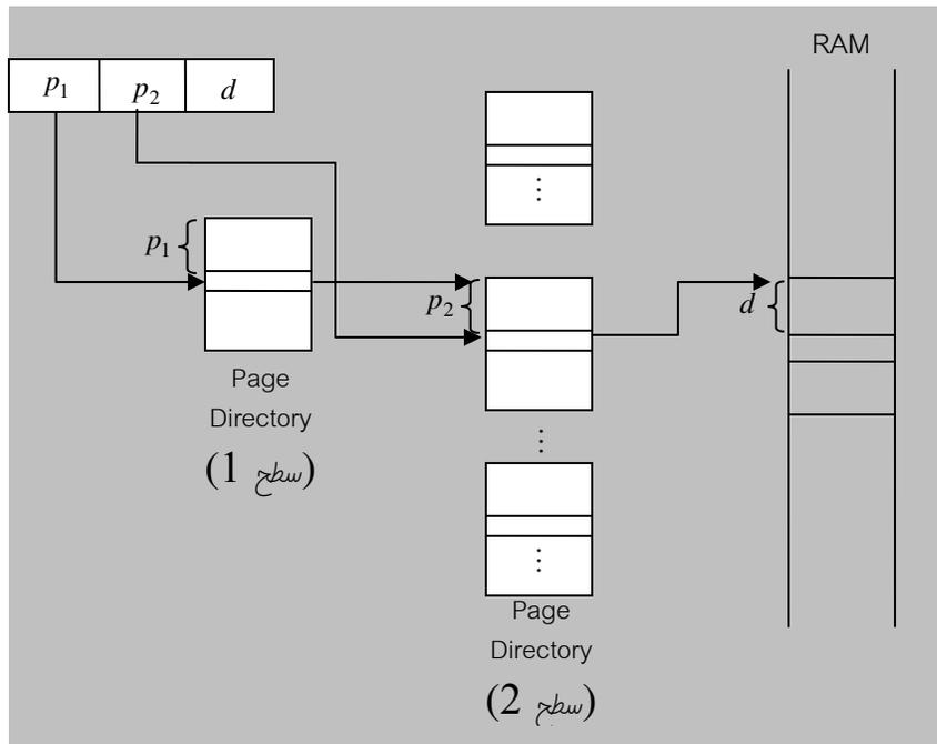
بدین ترتیب هر پردازش یک *page Directory* با  $(2^{10} = 1k)$  هزار ورودی دارد که هر ورودی آن می تواند به یک *page Table* اشاره کند که آن نیز  $(2^{10} = 1k)$  هزار ورودی دیگر دارد. برای هر پردازش همواره *page Directory* در حافظه قرار می گیرد ولی *page Table* های سطح 2، به تعداد لازم در حافظه قرار می گیرند.
