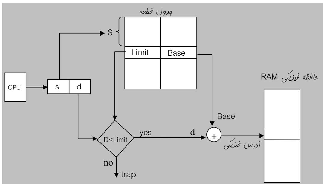
آدرس منطقی از دو جزء شماره قطعه (s) و آفست درون آن قطعه (d) تشکیل یافته است.
