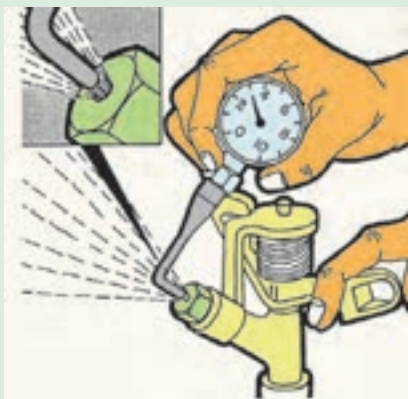
شکل ۳۵-۵. اندازه گیری با فشار سنج بوردون
