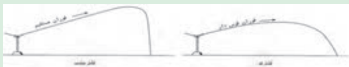
شکل ۳۴-۵. شکل فوران آب از آبیاش در فشار های مختلف
