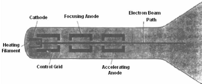
یک پرتو الکترونی توسط تفنگ الکترونی منتشر میشود. سپس از سیستم کانونی<sup>۲</sup> و سیستم انحراف<sup>۳</sup> که پرتو را به یک نقطه معین روی صفحه فسفر هدایت میکند میگذرد.
