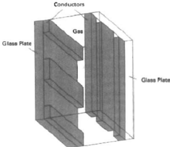
اعمال یک ولتاژ گرمایشی به هر جفت از هدایت کننده های افقی و عمودی موجب میشود گاز موجود در تقاطع دو نوار هادی به ذرات پلاسمای تابان از یونهای و الکترونها تبدیل شود. الگوی تصویر در Refresh Buffer ذخیره میشود و سپس ولتاژ گرمایشی در هر ثانیه 60 بار اعمال میشود.
