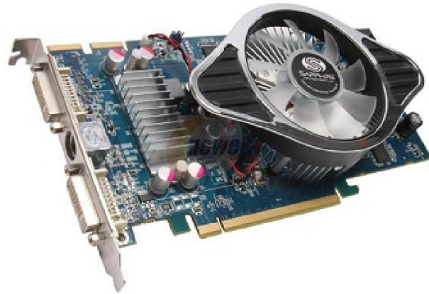
شکل ۱-۱۴- کارت گرافیکی با رابط PCI-EXPRESS
