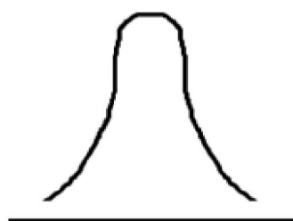
شکل ۱-۵- توزیع شدت نمایش نقاط فسفری در یک صفحه نمایش CRT
