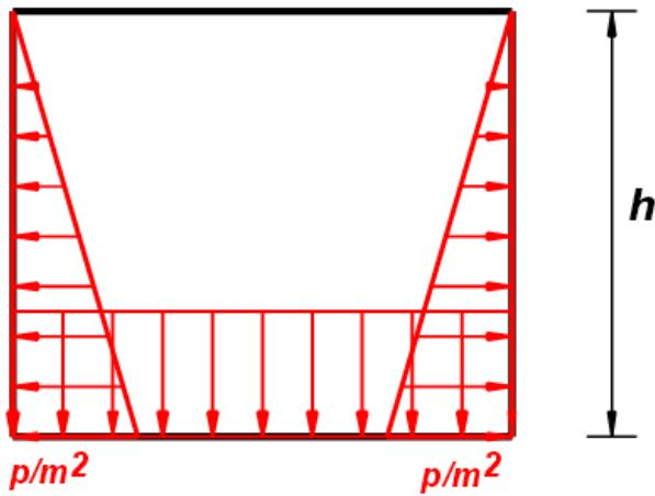
زمانی که کالورت پر از آب است، توزیع فشار روی دیواره ها مثلثی و با ماقزیمم مقدار  $p = \gamma_w h$  در پایین، فرض می گردد.
