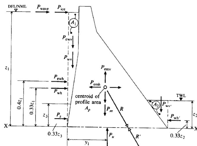
تمام بارهایی که مشخص می شوند، قابل اعمال به تمامی انواع سد نیستند. بارهایی که در زیر به آن ها می پردازیم، در ارتباط با آنالیز مقطع سد وزنی (نمایش داده شده در تصاویر) می باشند.
