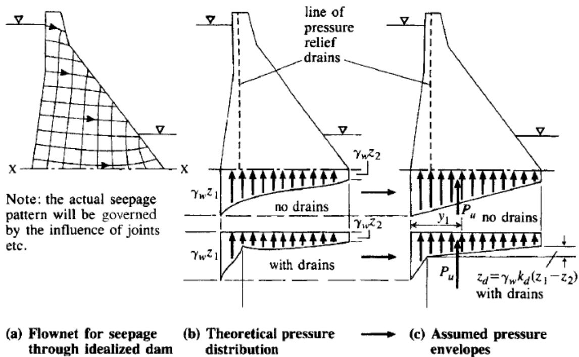
در صورتی که در مقطع سد زهکش هایی جهت تخلیه فشار تعییه شده باشند، داریم:
