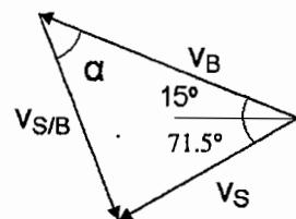
مثال: بلوک A با شتاب ثابت  $80 \text{ mm/s}^2$  به سمت چپ درحال حرکت است و بلوک B با شتاب نسبی ثابت  $120 \text{ mm/s}^2$  به سمت بالا روی بلوک A در حال حرکت است. مطلوبست شتاب مطلق B.
