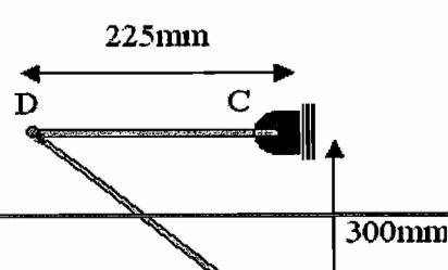
مثال : اگر در حالت نشان داده شده سرعت زاویه ای برابر  $3 \text{ rad/s}$  باشد ، مطلوب است :  $\omega_{BD}, \omega_{DC} = ?$
