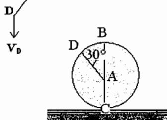
مثال : اتومبیلی با سرعت ثابت  $50 \text{ km/h}$  در حال حرکت در جهت راست می باشد . اگر قطر چرخهای اتومبیلی  $610 \text{ mm}$  باشد ، مطلوب است ، سرعت نقاط D,C,B,A ؟
