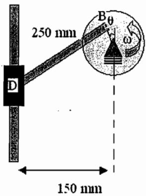
مثال : اگر یک دیسک با سرعت زاویه ای ثابت  $\omega = 500 \text{ rpm}$  در حال دوران باشد، مطلوب است : سرعت طوقه D در حالت  $\theta = 0^\circ$ ,  $\theta = 90^\circ$  (فاصله نقطه B تا مرکز دیسک 50 mm می باشد)
