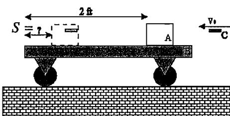
مثال: گلوله C با سرعت  $v_0$  به سمت جسم A شلیک می‌گردد و در آن فرو می‌رود و باعث حرکت جسم A روی گاری B و حرکت گاری می‌گردد. مطلوب است:
