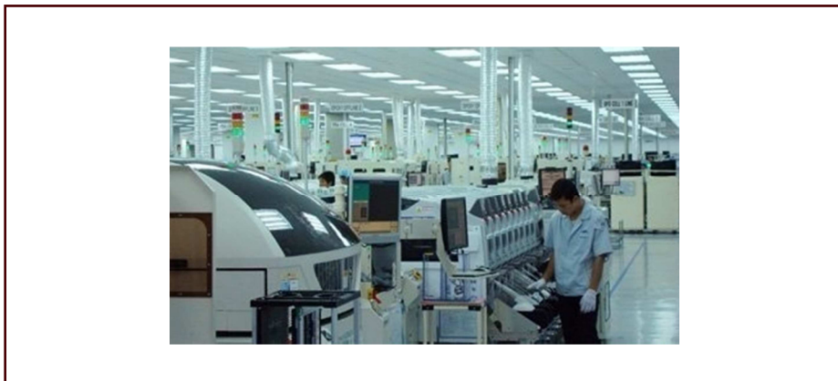
شکل ۲۸- روشنایی مناسب در یک کارگاه تولید نمایشگر
