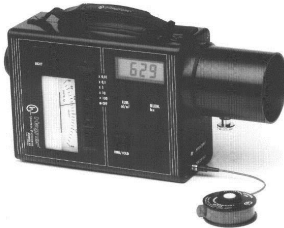
شکل (۱۱) دستگاه پیشرفته اندازه‌گیری شدت روشنایی و درخشندگی
